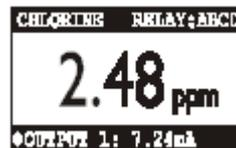
在 MEASURE (测量) 屏的顶行，继电器 A、B、C 和 D 在它们的继电器运行状态改变时，信号器将显示出来。当使用继电器过量定时功能，并且时间终止时，各继电器的信号器将连续闪烁，直到过量状态被解除。
