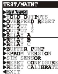
1. 随着屏幕显示
