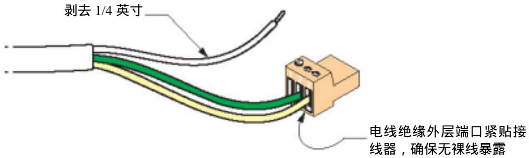
图13 报警器接线
